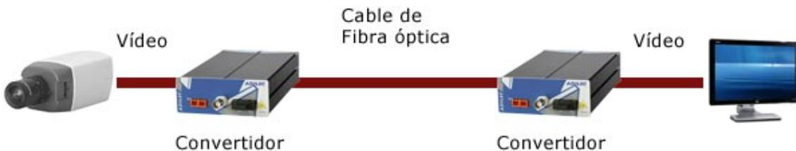
El empleo de este sistema de transmisión de señal HD-SDI permite, entre otras ventajas la observación directa de los detalles de cualquier imagen en tiempo real, empleando directamente el zoom digital, sin los inconvenientes de pixelado de las de definición SD o HD. Lo mismo sucede con las imágenes ya registradas.
